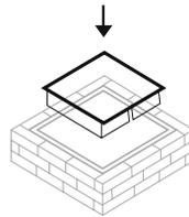
Insérer les 2 pièces de la cuve intérieure.
