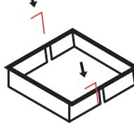
Insérer les 2 tiges pour joindre les 2 pièces de la cuve intérieure ensemble.
